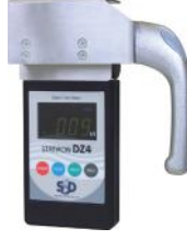
인체 대전 측정 Plate(옵션) 형식: ODZ4-HPLT 인체의 대전을 측정하는 것이 가능합니다.
